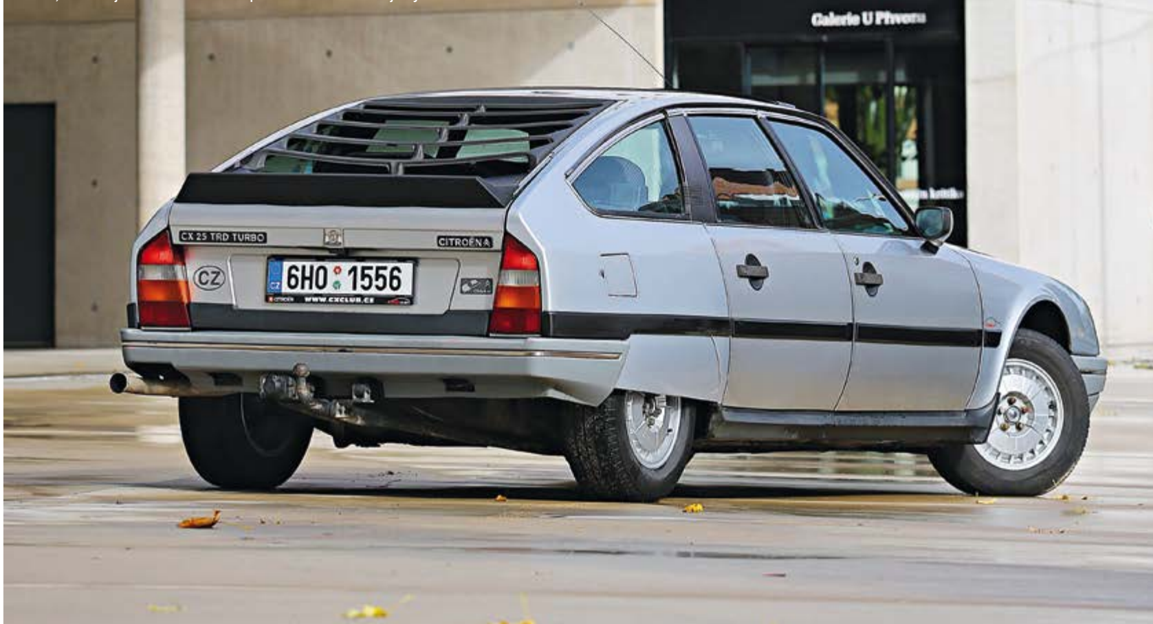
Futuristické tvary obou vlajkových lodí neměly šanci zestárnout, což ostatně není u Citroënu žádné překvapení. Charakteristická roleta na zádi CX byla za příplatek a zakrývá pohled na konkávní tvar zadního okna, umožňující samočištění skla proudem vzduchu za jízdy.
